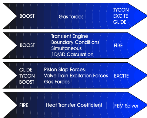
Рис. 3. Обмен данными между инструментами моделирования концепции виртуального автомобиля.
